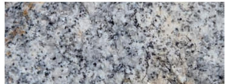
Der Brixner Granit, ein magmatisches Tiefengestein (Erstarrungsgestein), weist eine gleichmäßige, mittelkörnige Struktur auf.
